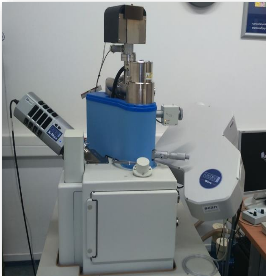
Скенирајући електронски микроскоп (JEOL-JSM-661 OLV, Токуо, Јапан) Рударско-геолошки факултет Универзитета у Београду (фотографија из докторске дисертације др Дајане Ного – Живановић, менторство: проф. др Ирена Танасковић)
